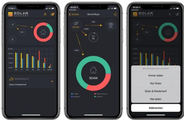
Das intelligente System verhindert, dass die Verbraucher mit teurem Strom aus dem Netz betrieben werden, solange Solarstrom vorhanden ist.
