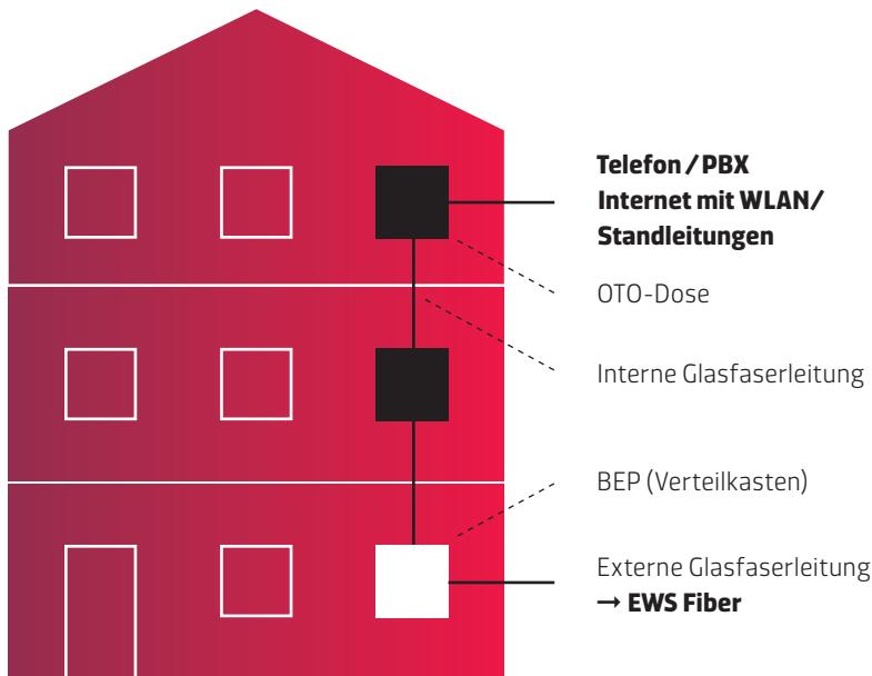
Das Glasfaserkabel wird bis zum Übergabepunkt im Gebäude verlegt (BEP). Der Installateur zieht das Kabel vom Übergabepunkt bis zum Standort des Modems. Dort endet der Anschluss mit einer OTO-Dose, an der das Modem (DRG) angeschlossen wird. Das Modem ist mit den Anschlüssen für zwei analoge Telefongeräte, 4 LAN-Anschlüssen, WLAN sowie den Anschluss für TV-Coaxialkabel ausgerüstet.
